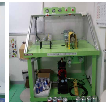
カプラー残圧衝撃体感装置
